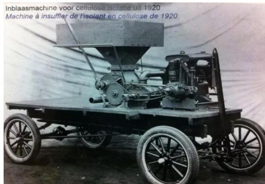
Inblaasmachine voor cellulose isolatie uit 1920
